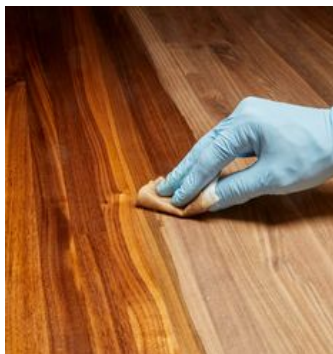
Slika 8. Nanošenje ulja krpom
