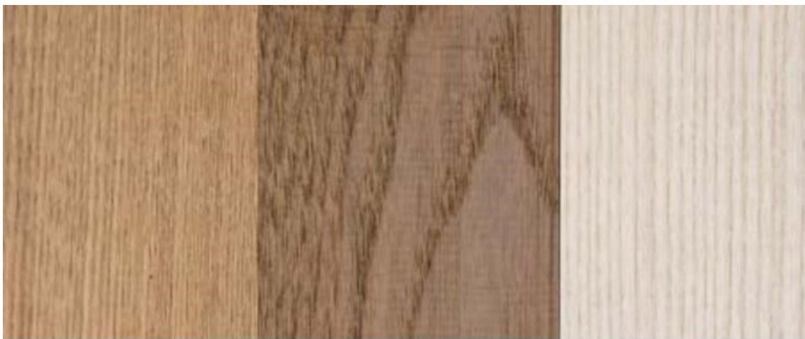
Slika 22. Prirodna jasenovina (desno) i toplinski obrađena jasenovina pri različitim temperaturama (lijevo i u sredini) ( foto: Turkulin )
