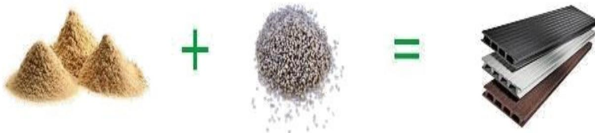
Slika 18. Kompozitni materijal sastavljen od drva, u bilo kojem obliku i polimer
