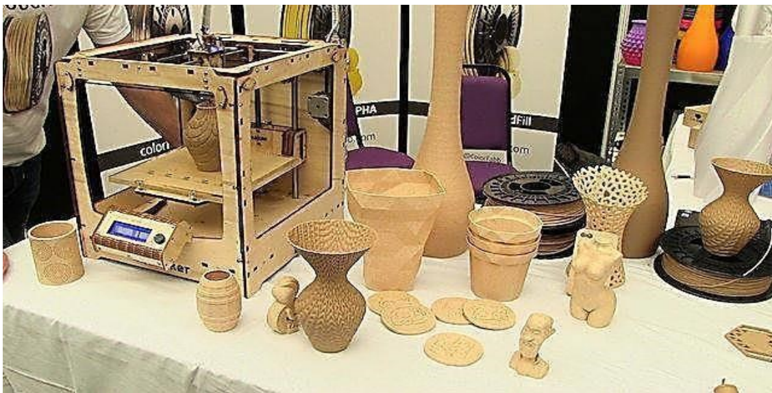
Slika 20: 3D drveni pisač i tiskani modeli tvrtke Laywoo-D3. (Kitchoukova, Staneva)
