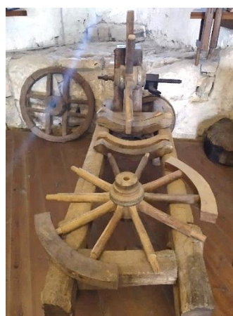
Slika 58. Stroj za izradu kola Fotografija: Mogorović, 2021.
