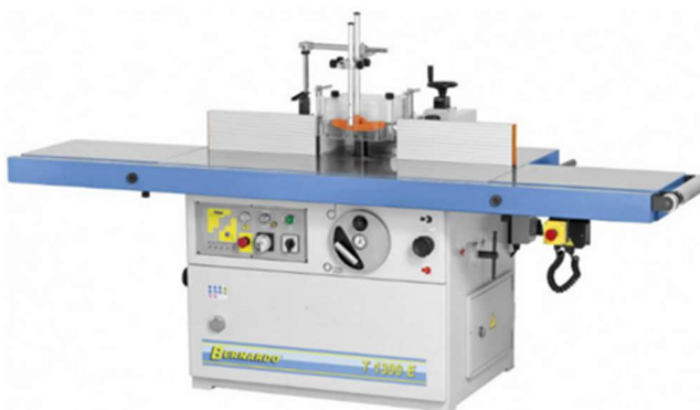
Slika 24. Stolna glodalica sa krutom osovinom T 1300 E ( https://www.stokker.com/ )
