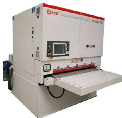
Slika 25. Širokotračna brusilica Sandya 900 ( https://wtp.hoechsmann.com/ )
