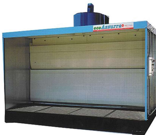
Slika 29. Vodena kabina za lakiranje P4 A ( https://hudek-zagreb.hr/ )
