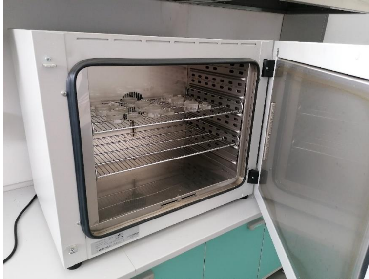
Slika 9. Zagrijavanje praznih posudica u sušioniku Binder FD 115
