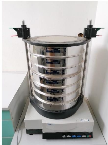
Slika 7. Oscilator za granulometrijsku analizu Retsch AS 400 control
