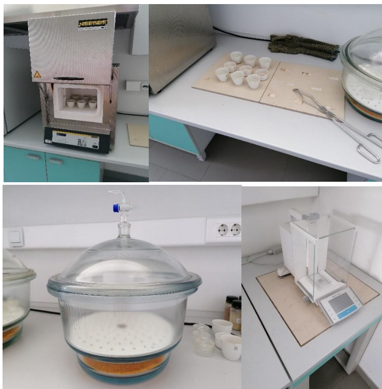
Slika 8. Određivanje masenog udjela pepela
