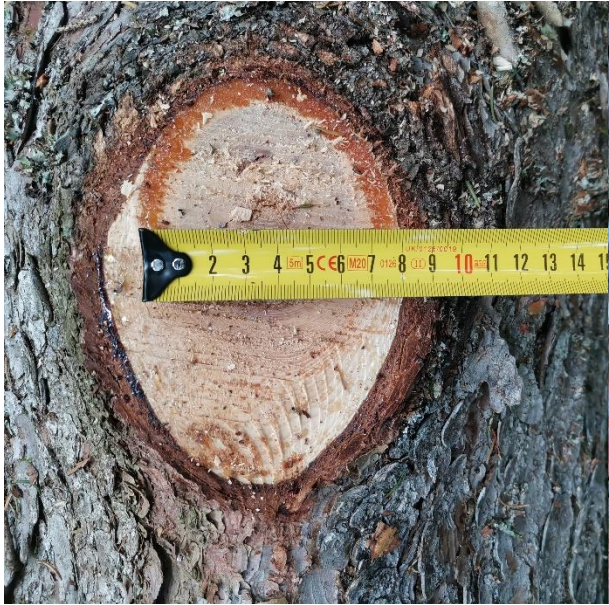
Slika 15: Zdrava kvrga promjera većeg od 60 mm
