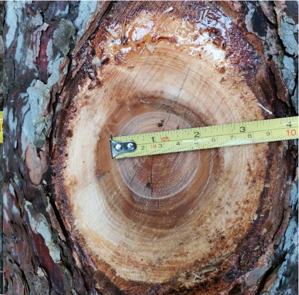
Slika 16: Zdrava kvrga promjera manjeg od 60 mm
