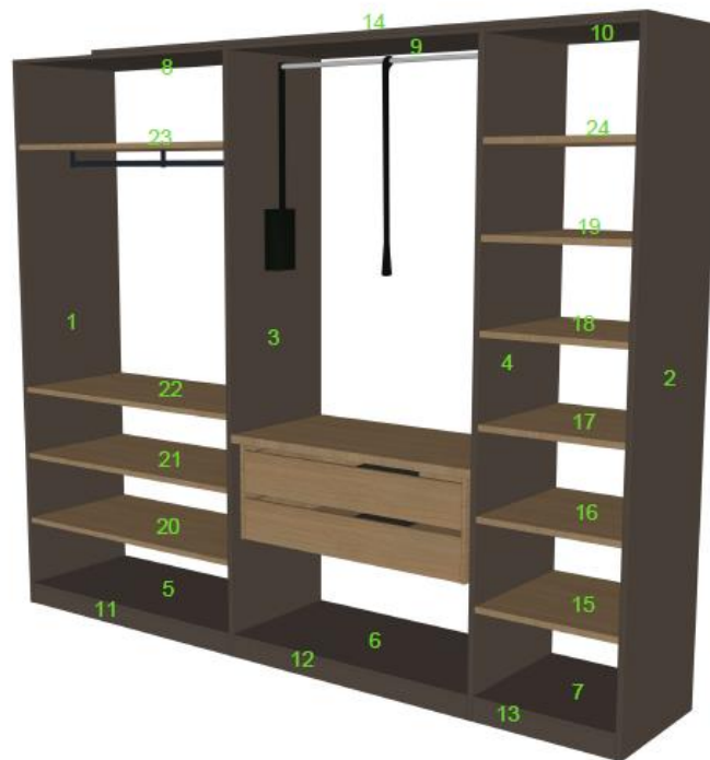
Slika 38 Desni ormar dimenzija 3000x600x2500 mm
