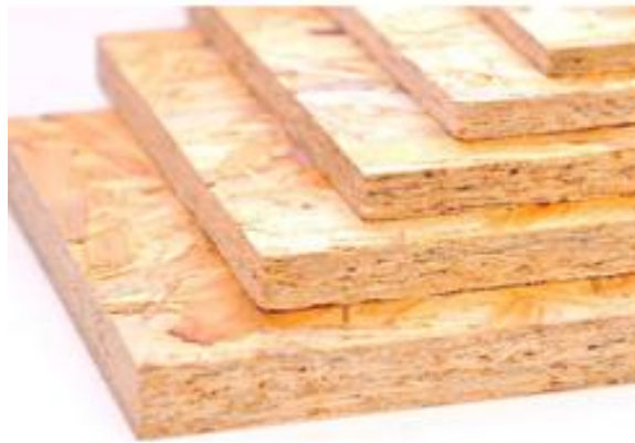
Slika 14 Ploča s orijentiranim makro iverjem
