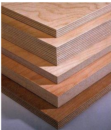
Slika 16 Različite vrste i debljine furnirske ploče
