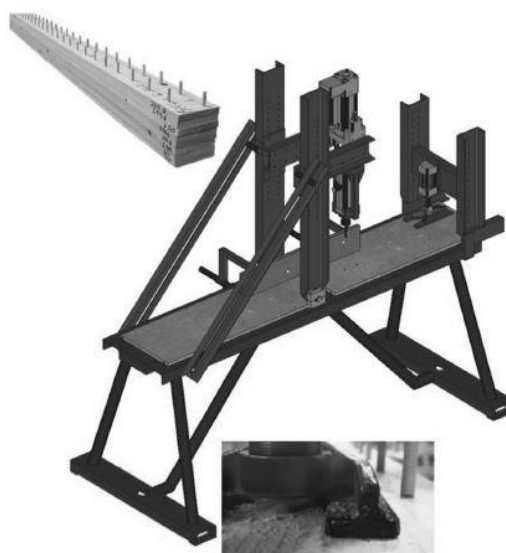
Slika 16. Stroj za zavarivanje kod proizvodnje višeslojnih greda (Bocquet i dr. 2006)
