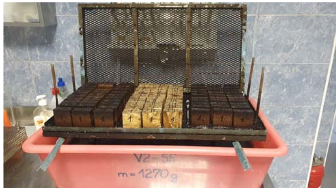
Slika 8. Kavez s uzorcima i posuda za uranjanje
