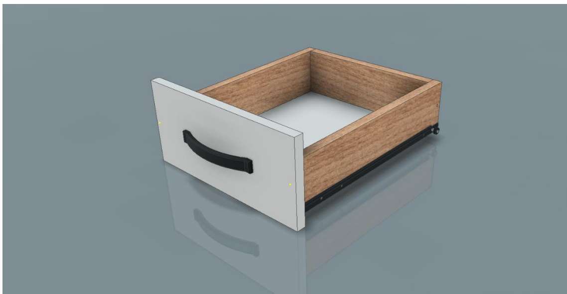
Slika 19 Prikaz sklopa ladice nacrtan u Inventoru
