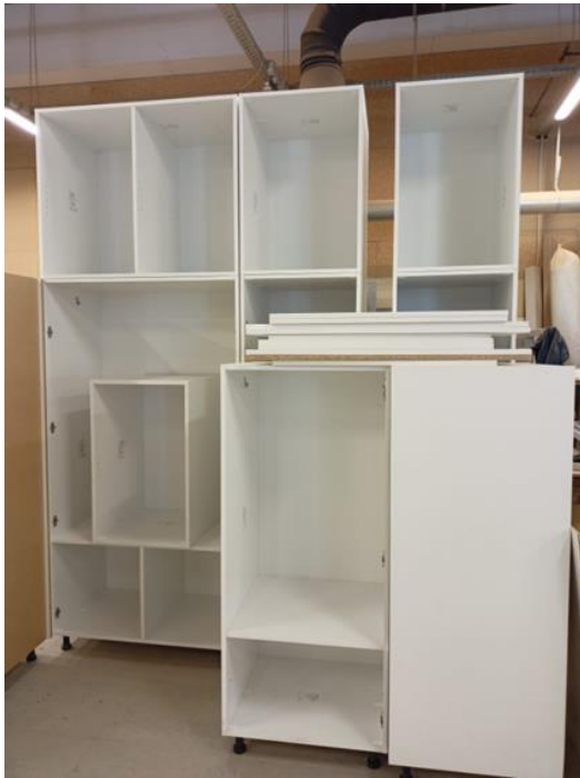
Slika 25. Sastavljeni elementi ormara
