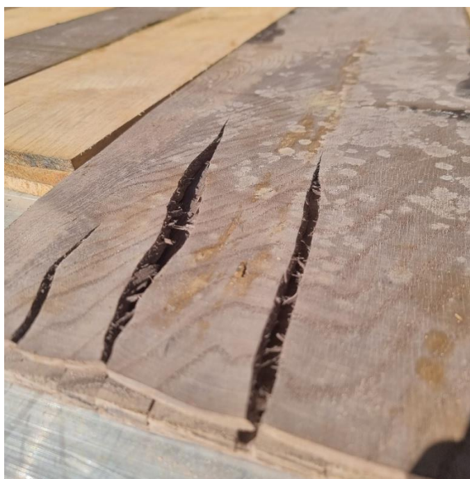
Slika 38. Čeone pukotine na uzorcima abonosa i gljive
