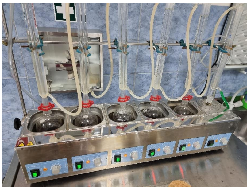
Slika 25. Uzorci abonosa u laboratorijskoj vodenoj kupelji
