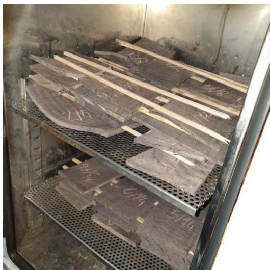
Slika 20. Uzorci abonosa u sušioniku
