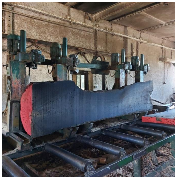
Slika 5. Raspiljivanje trupca abonosa na tračnoj pili trupčari
