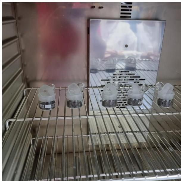
**Slika 24.** Uzorci drvnog iverja abonosa u sušioniku
