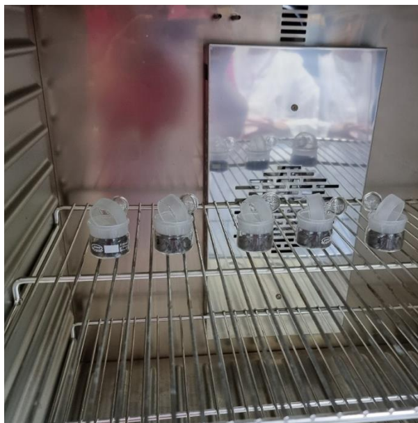
Slika 24. Uzorci drvnog iverja abonosa u sušioniku
