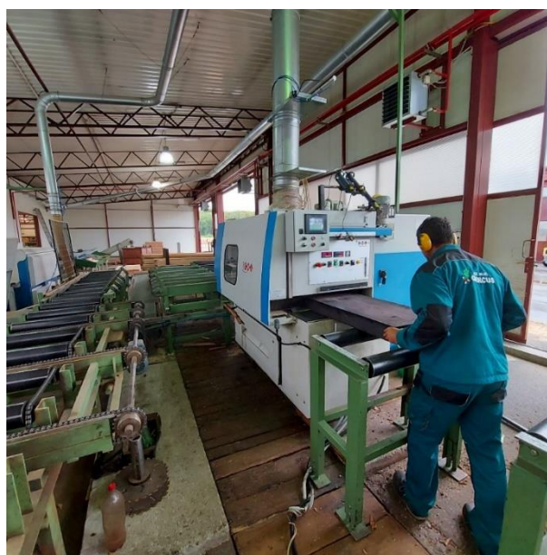
Slika 6. Obrada piljenica abonosa na višelisnoj kružnoj pili
