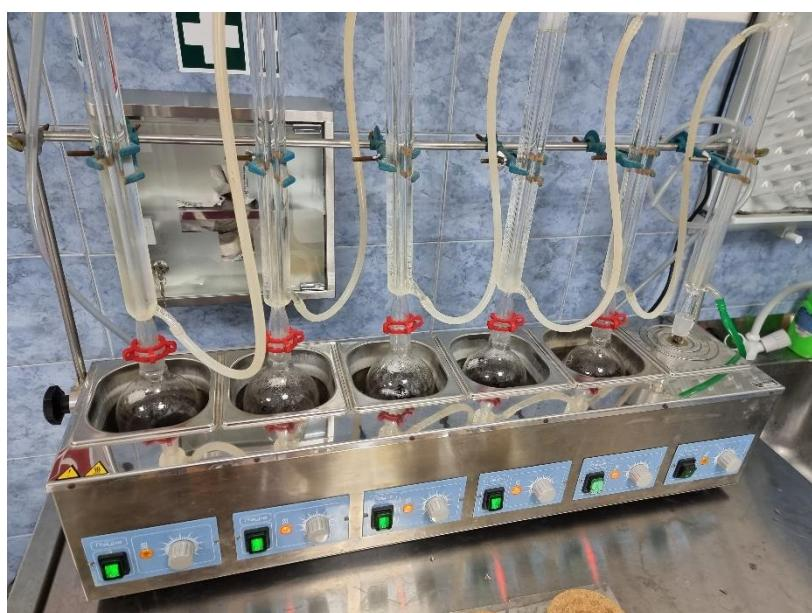
**Slika 25.** Uzorci abonosa u laboratorijskoj vodenoj kupelji
