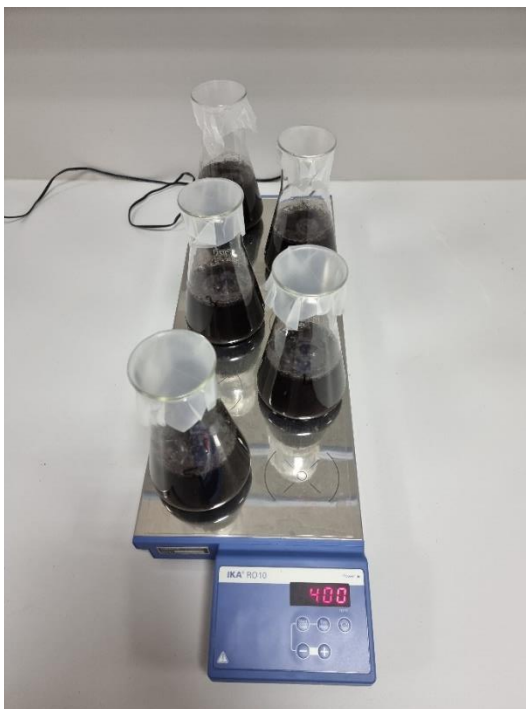
Slika 28. Ekstrakcija na elektromagnetskoj miješalici
