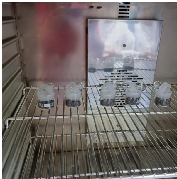
Slika 24. Uzorci drvnog iverja abonosa u sušioniku
