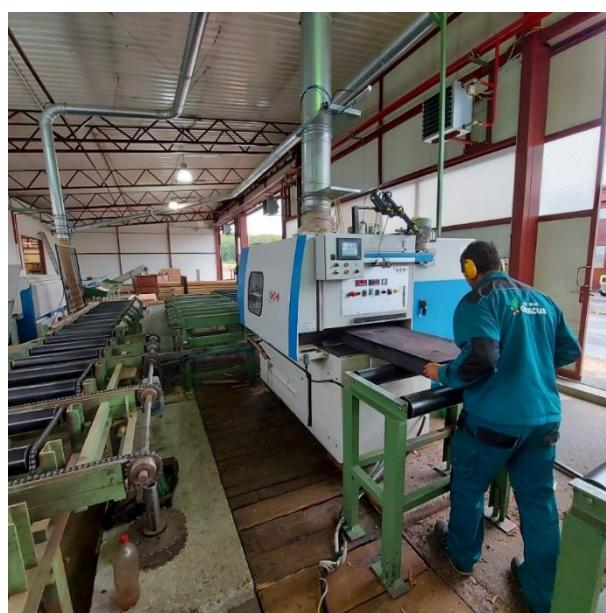
*Slika 6. Obrada piljenica abonosa na višelisnoj kružnoj pili*
