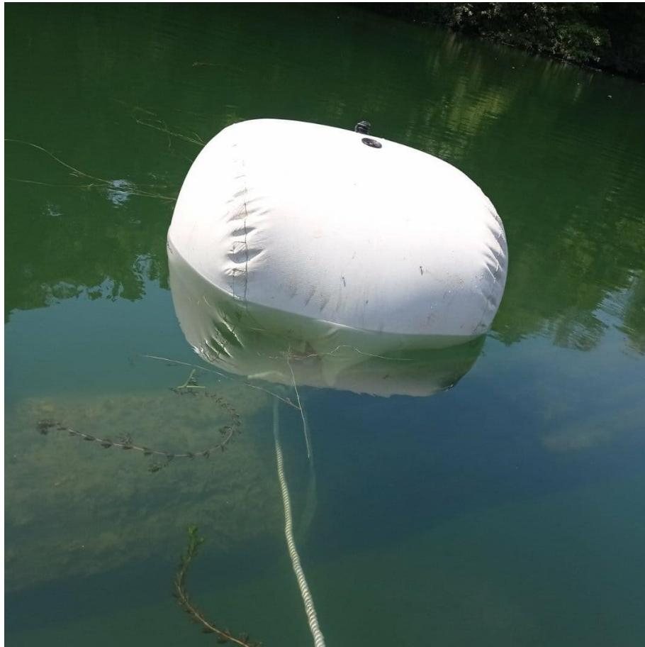
*Slika 1. Podizanje trupaca na površinu vode zračnim balonom*
