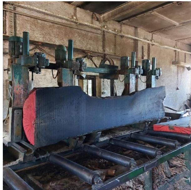
*Slika 5. Raspiljivanje trupca abonosa na tračnoj pili trupčari*
