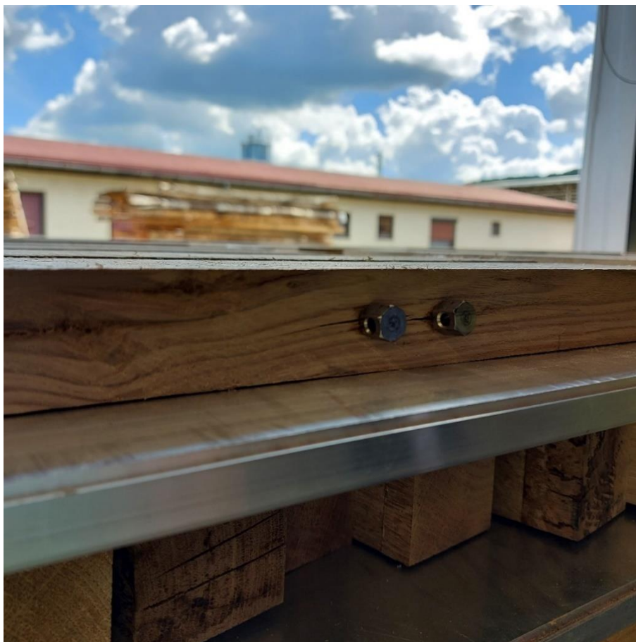
Slika 18. Sonde za kontrolu sadržaja vode tijekom sušenja
