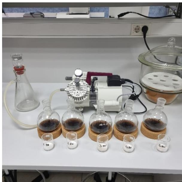
*Slika 26. Vakuum filtracija uzorka abonosa*
