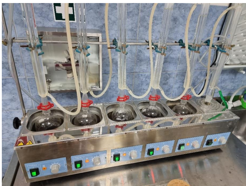
Slika 25. Uzorci abonosa u laboratorijskoj vodenoj kupelji
