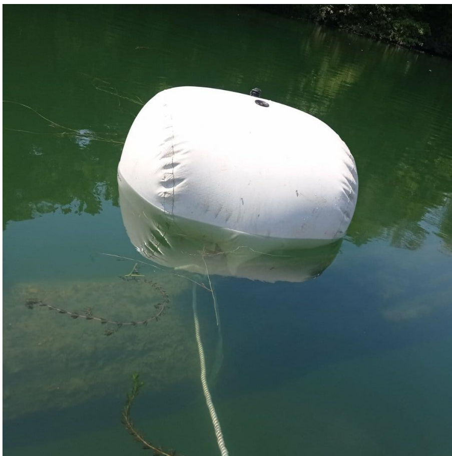
Slika 1. Podizanje trupaca na površinu vode zračnim balonom
