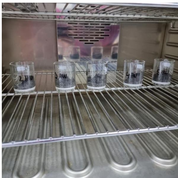
Slika 27. Ekstrahirani uzorci abonosa u sušioniku
