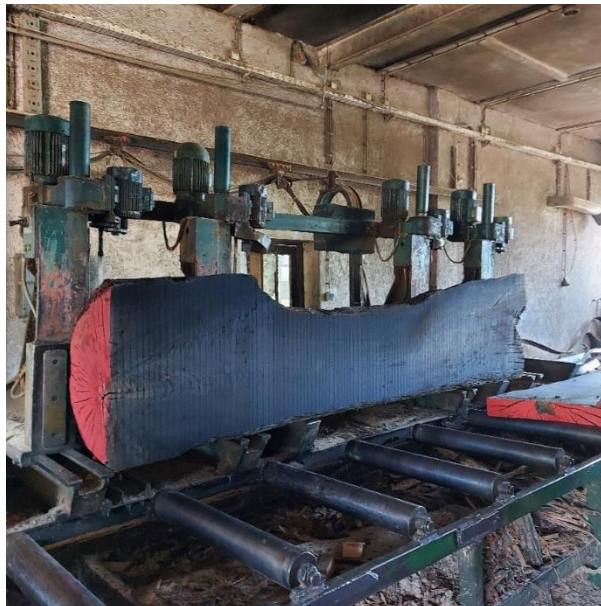
Slika 5. Raspiljivanje trupca abonosa na tračnoj pili trupčari
