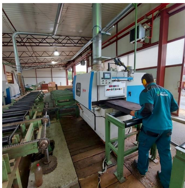
Slika 6. Obrada piljenica abonosa na višelisnoj kružnoj pili
