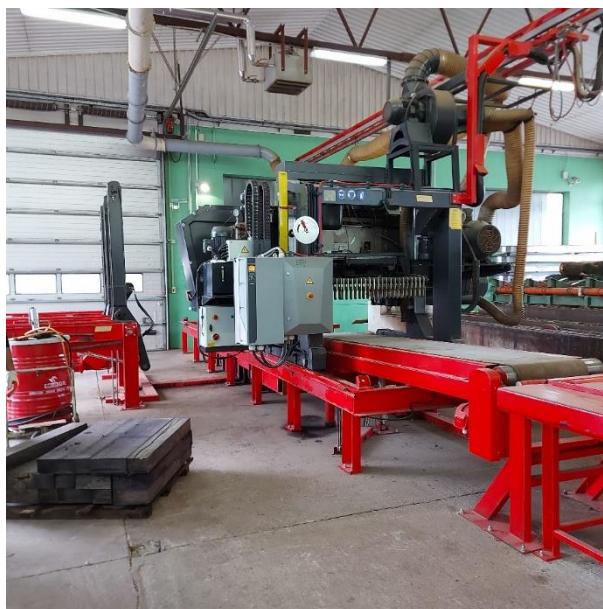
Slika 7. Obrada piljenica abonosa na horizontalnoj pili za rezanje tankog furnira
