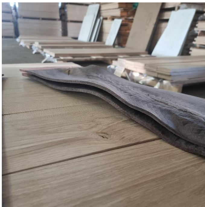
Slika 40. Izvitopereni uzorak abonosa
