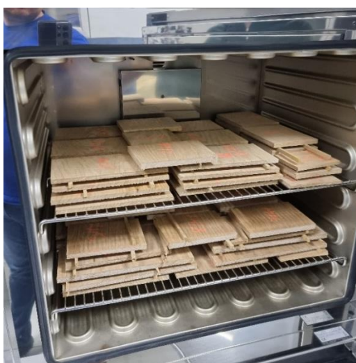
Slika 19. Uzorci recentnog hrasta u sušioniku
