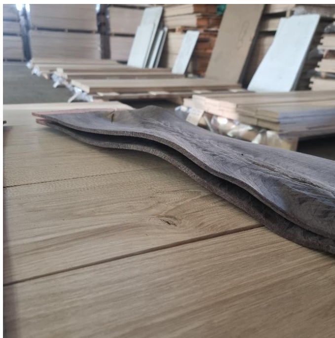
Slika 40. Izvitopereni uzorak abonosa
