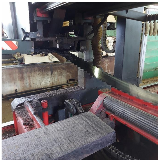
Slika 12. Pila s obostranim nazubljenjem
