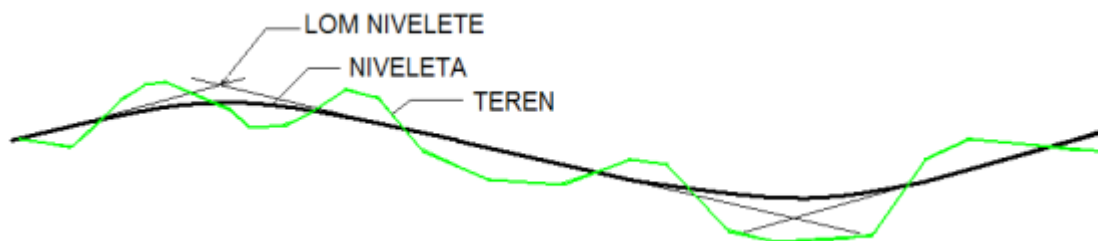
Slika 2. Element ceste u nacrtu
