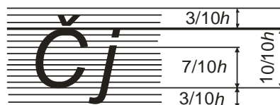
Slika 2.3 Dimenzije značajki tehničkoga pisma
