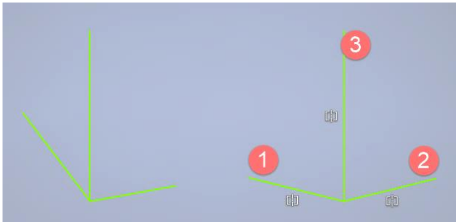
Slika 3.57 Dobivanje simetričnosti objekata primjenom geometrijskoga ograničenja Symmetric
