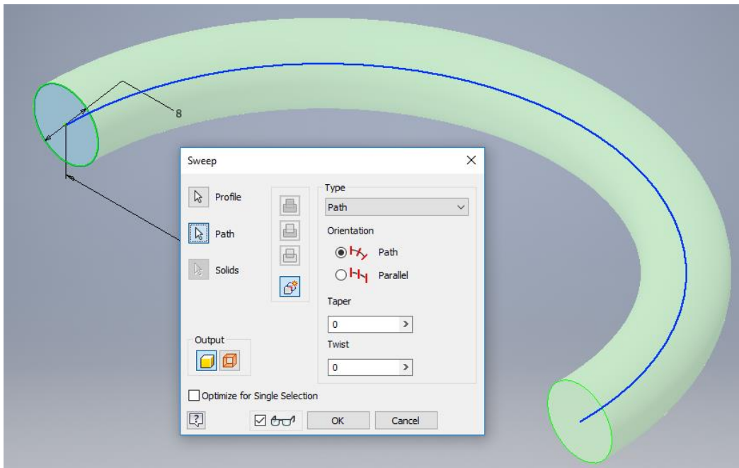
Slika 4.45 Izvedba prihvatnika naredbom Sweep okomite orijentacije na krivulju
