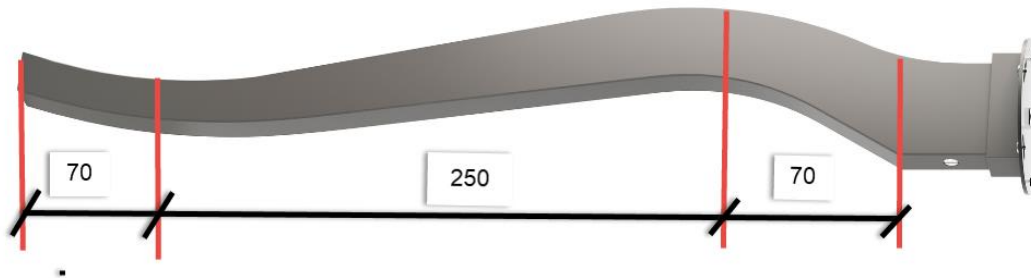
Slika 4.62 Dimenzije i oblik kopirno glodane noge
