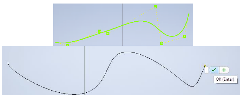
Slika 3.7 Crtanje krivulje zadavanjem kontrolnih točaka
