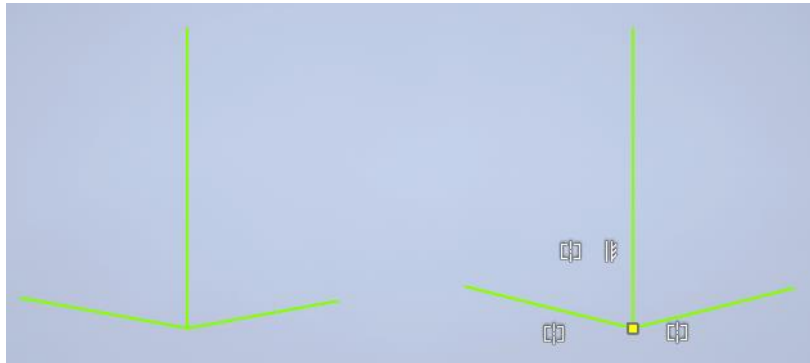
Slika 3.59 Vidljivost simbola geometrijskih ograničenja
