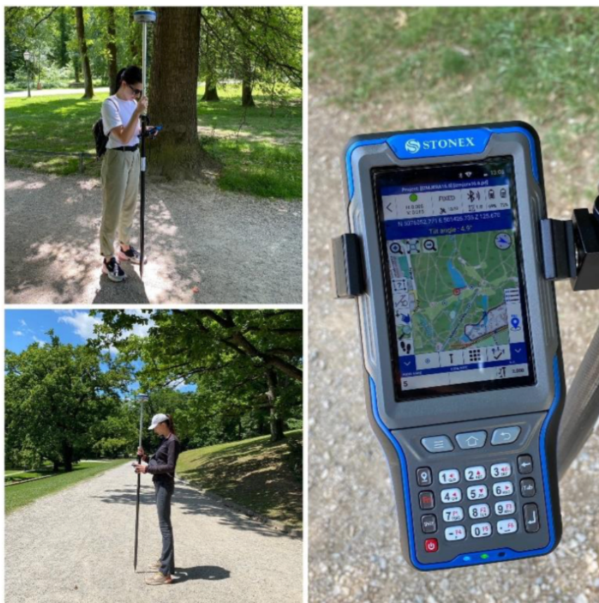
Slika 14. Izmjera RTK GPS uređajem Stonex S900A s kontrolerom S40
