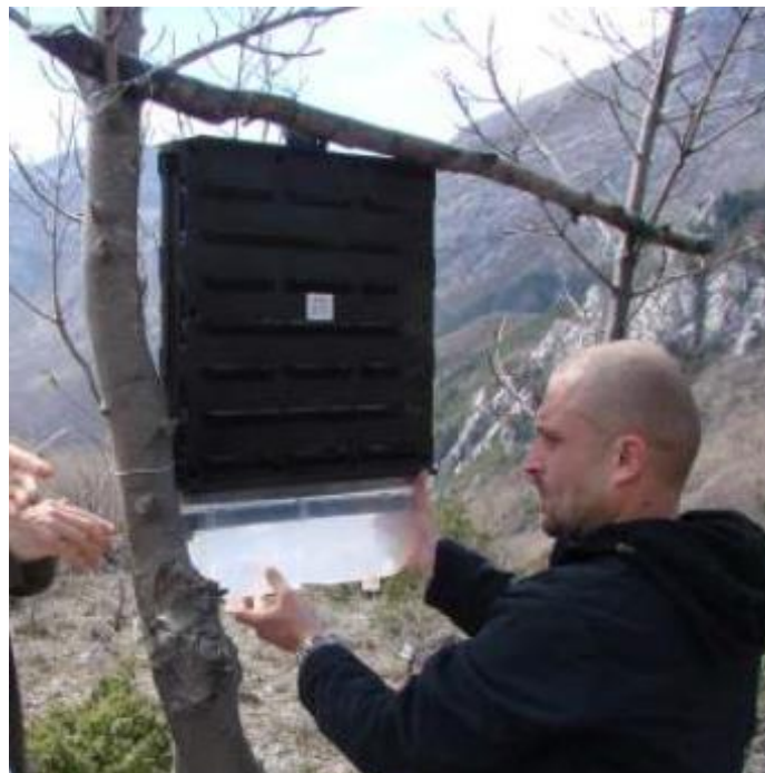
Slika 8. Naletno barijerna klopka tipa Theysohn (mokra) na lokaciji Ramići (autor: M. Franjević)
