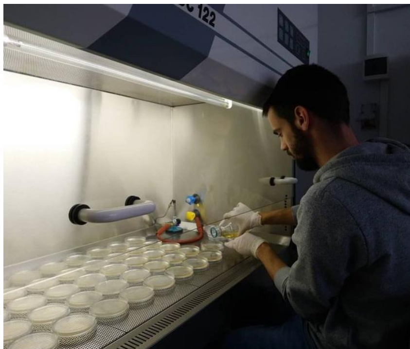
Slika 9. Rad u laminarnom kabinetu za rad u atmosferi čistog zraka (laminaru)
