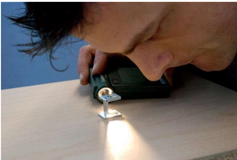
Slika 12. Ispitivanje detalja na brušenoj površini pomoću lupe i lampe ( https://www.bm-online.de/allgemein/gut-geschliffen-ist-halb-lackiert/#slider-intro-3 )
