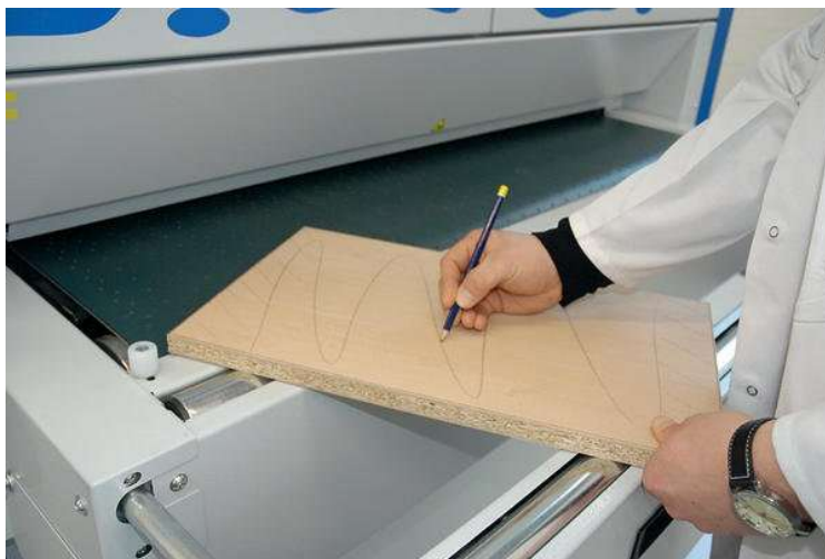
Slika 10. Test grafitnom olovkom ( https://www.bm-online.de/allgemein/gut-geschliffen-ist-halb-lackiert/#slider-intro-3 )
