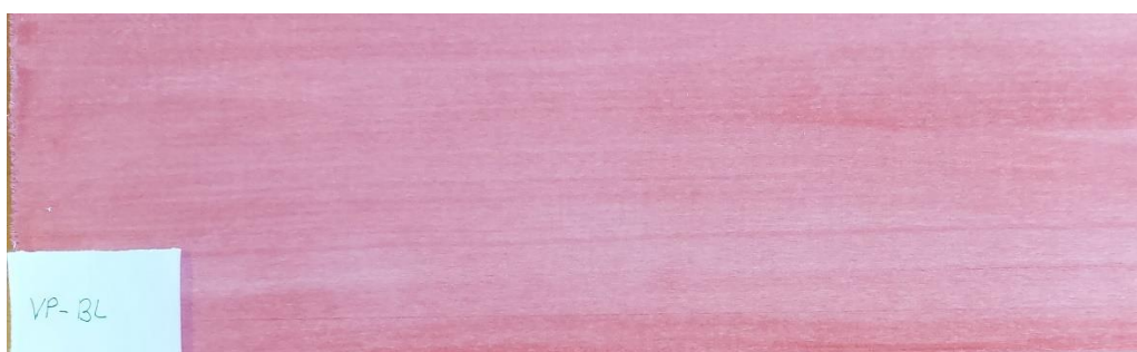
Slika 32. Vodeno močilo s pigmentima (VP) na blanjanjoj površini lipe
