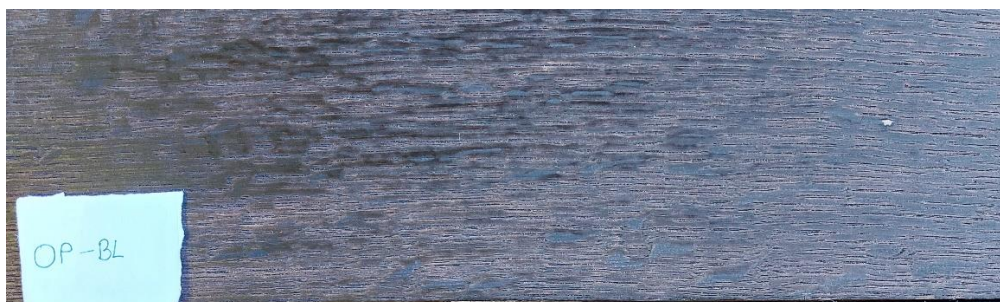
Slika 23. Otopalno močilo s pigmentima (OP) na blanjanjoj površini hrastovine
