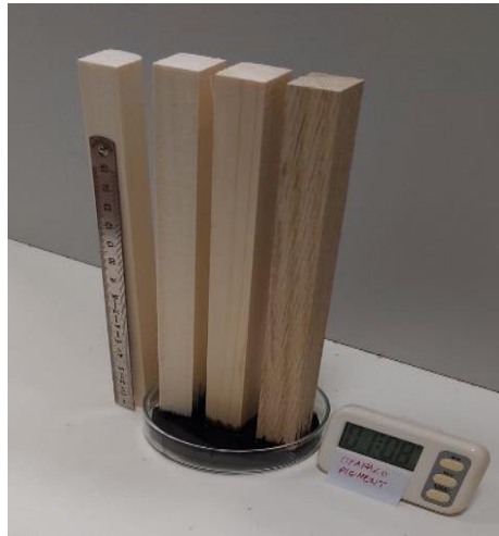
Slika 20. Postavljeni uzorci za ispitivanje brzine i dubine penetracije u uzdužnom smjeru
