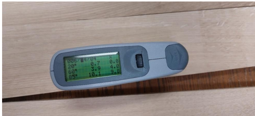
Slika 10. Mjerenje sjaja na uzorku hrastovine
