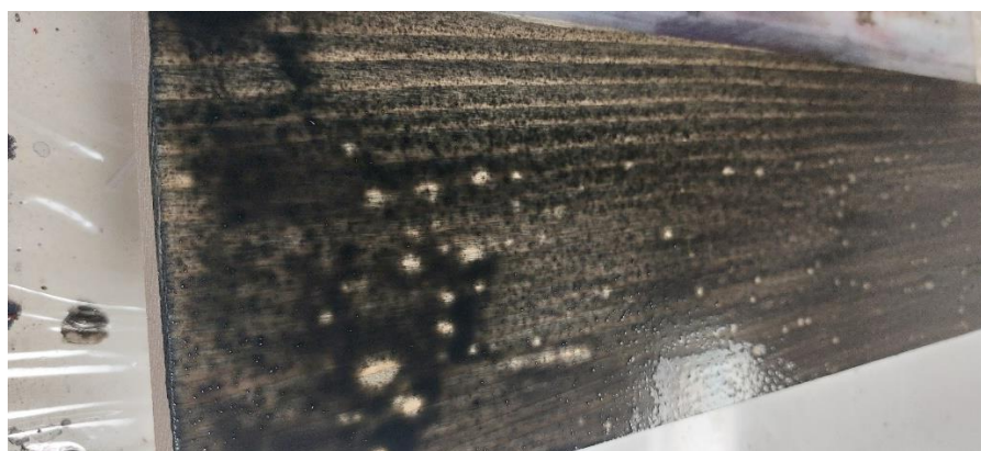
Slika 27. Razdvajanje močila na površini jelovine prilikom nanošenja
