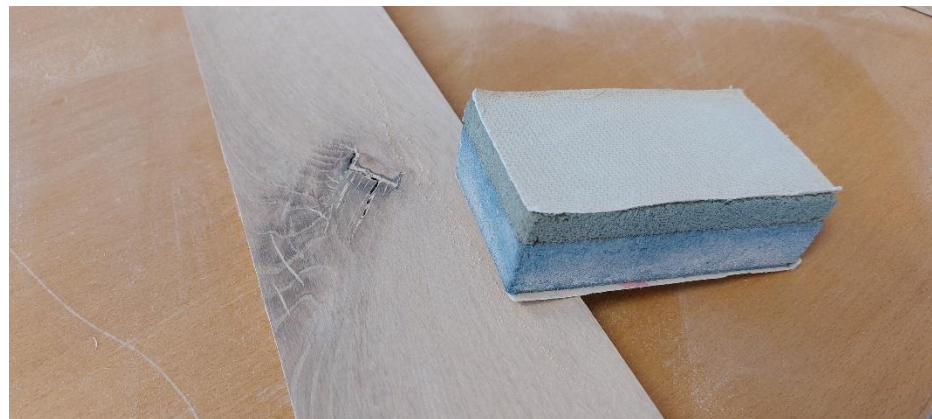
Slika 6. Ručno brušenje uzoraka nakon navlaživanja
