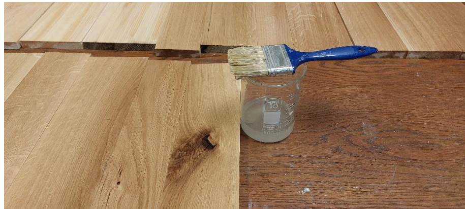
Slika 5. Navlaživanje uzoraka Hrastovine pomoću kista
