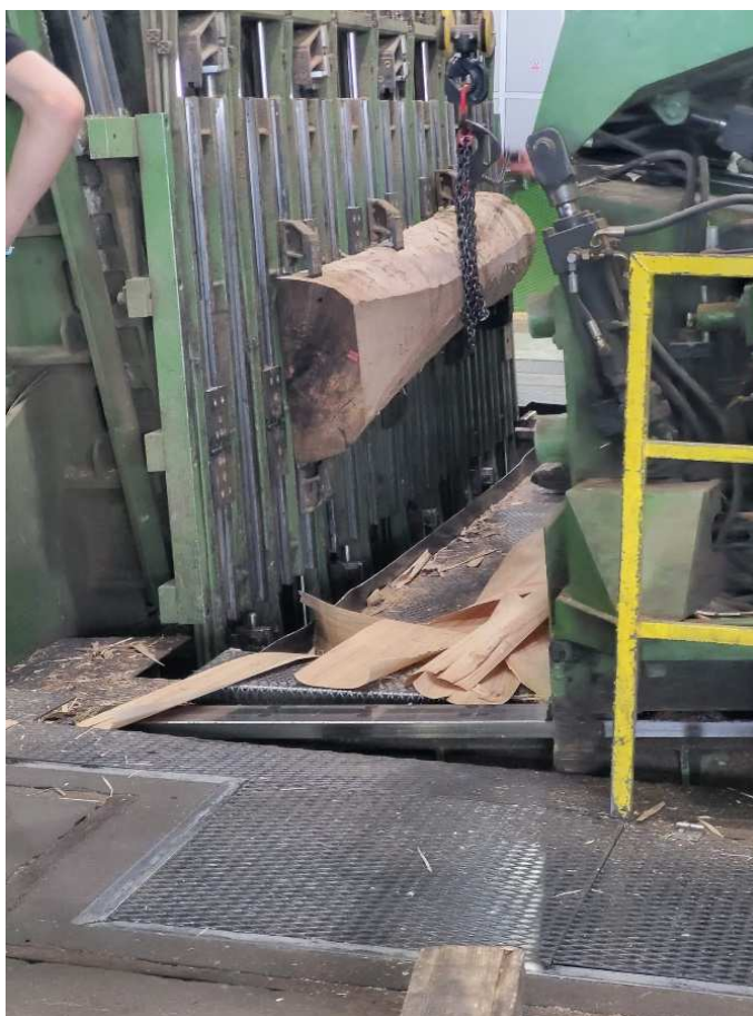
Slika 15. Prihvat polovnjaka na radni stol (foto: Ivanda., A., 2022.)
