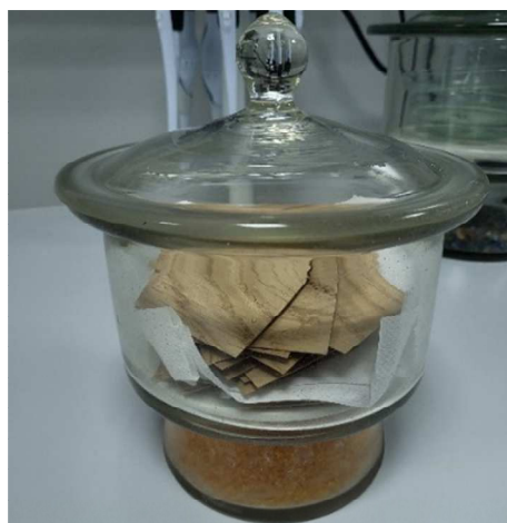
Slika 16. Uzorci položeni u eksikator (foto: Ivanda, A., 2022.)
