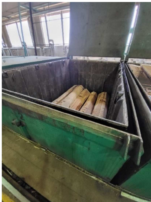
Slika 6. Jama za kuhanje trupaca (foto: Ivanda, A., 2022.)
