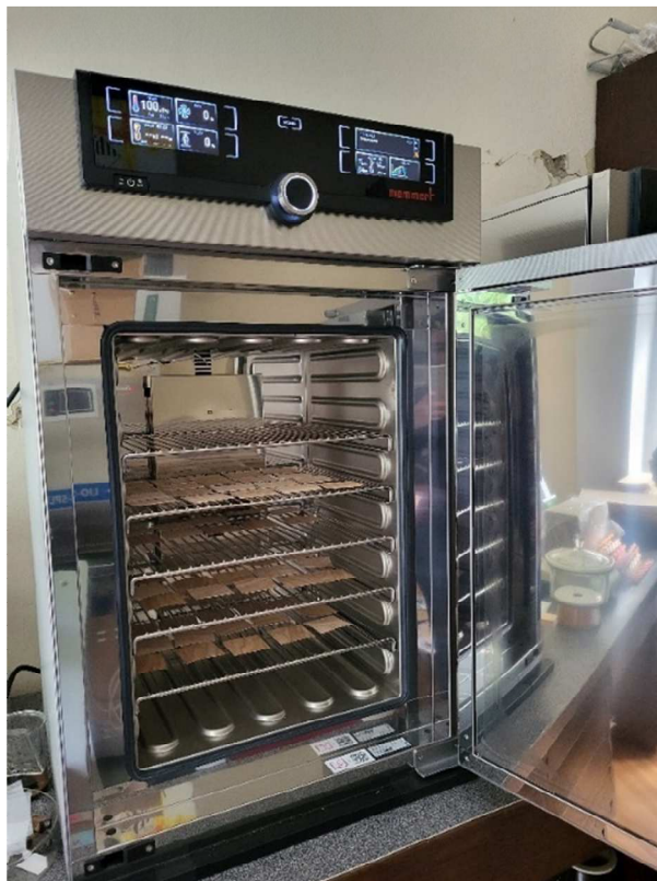
Slika 17. Sušionik sa uzorcima furnira (foto: Ivanda, A., 2022.)
