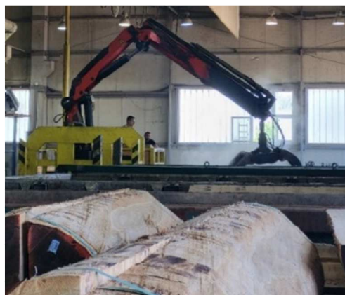
Slika 9. Podizanje i spuštanje trupaca kranom u jamu (foto: Ivanda, A., 2022.)
