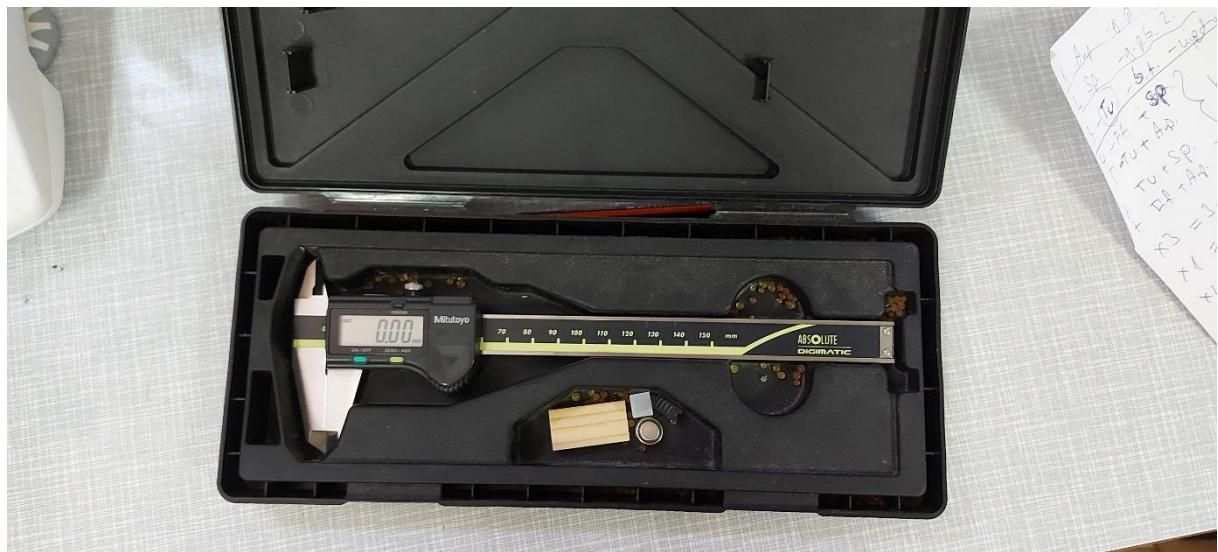
Slika 5. Prikaz pomičnog mjerila
