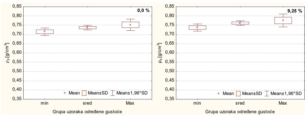
Slika 12. Gustoća drva bukve u absolutno suhom i kondicioniranom stanju
