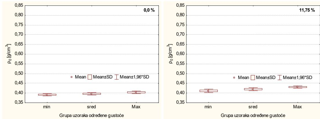
Slika 13. Gustoća drva bora u absolutno suhom i kondicioniranom stanju
