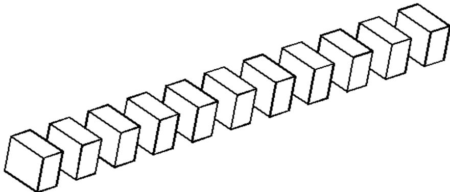
Slika 3. Shematski prikaz finog piljenja uzorka iz fino blanjanih četvrtaka
