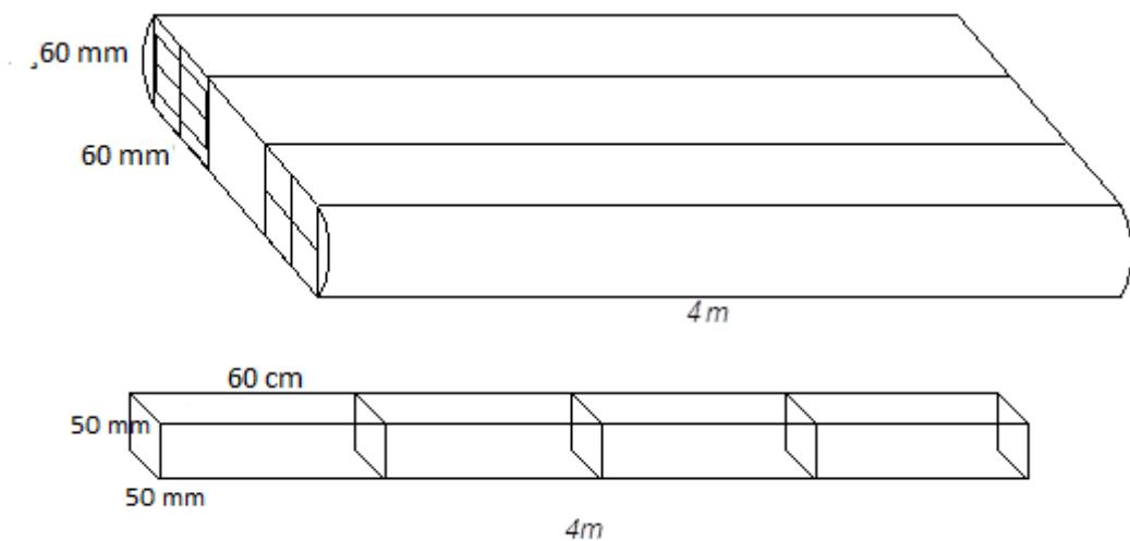
Slika 2. Shematski prikaz piljenja četvrtaka, elemenata i letvica za izradu uzorka
