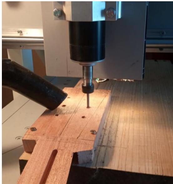
Slika 34. CNC bušenje rupa na glavi gitare
