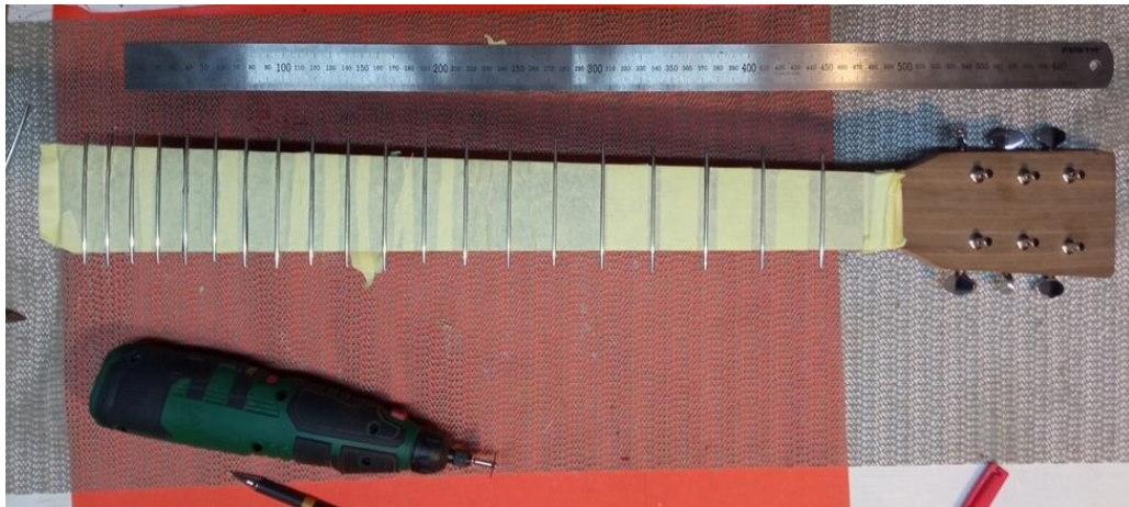
Slika 40. Postavljanje pragova na hvataljku gitare
