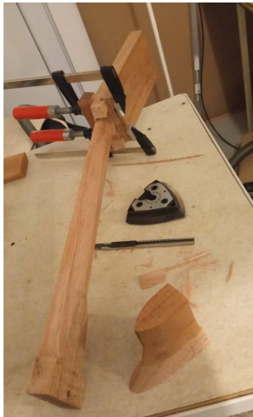
Slika 35. Slika vrata i segmenta pete gitare nakon CNC obrade
