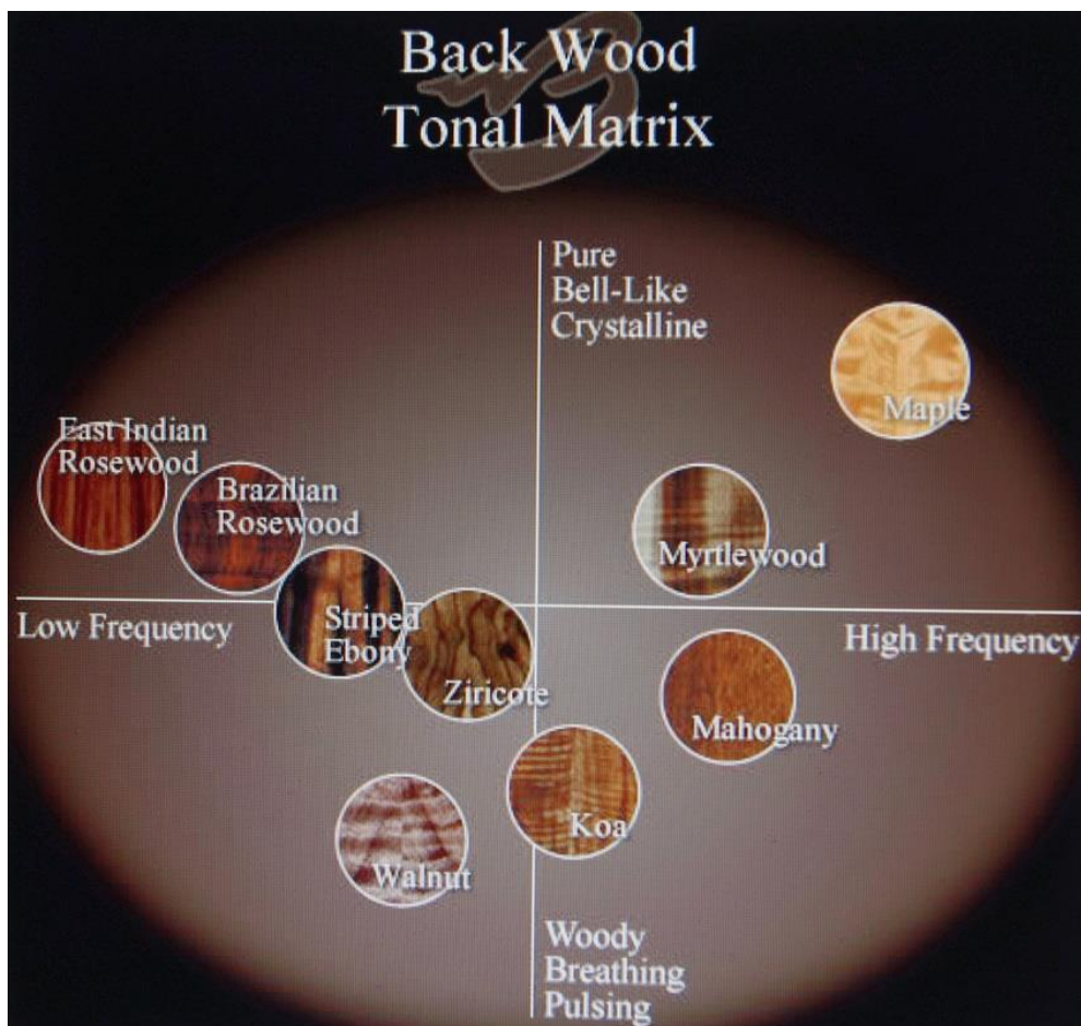
Slika 20. Utjecaj različitih vrsta drva, uobičajenih za izradu stražnje ploče i bočnih stranica gitare na subjektivni doživljaj tona (Anonimni autor, 2022.)
