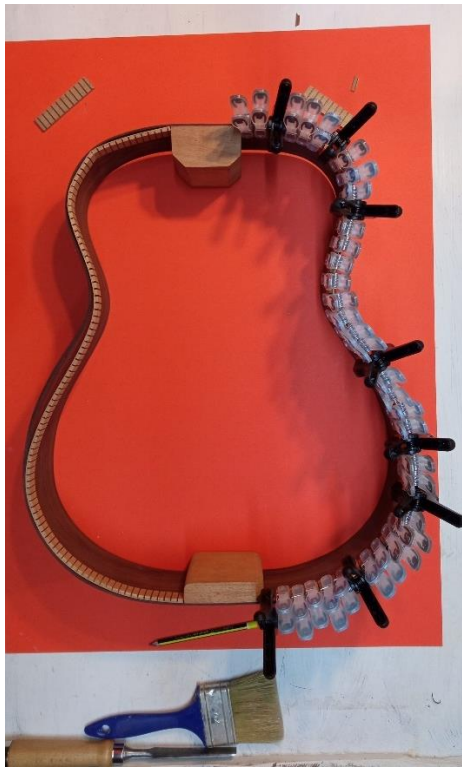
Slika 27. Lijepjenje savitljive drvene trake na bočne stranice nakon njihovog sastavljanja
