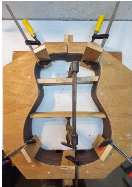
Slika 26. Učvršćivanje bočnih stranica u kalup
