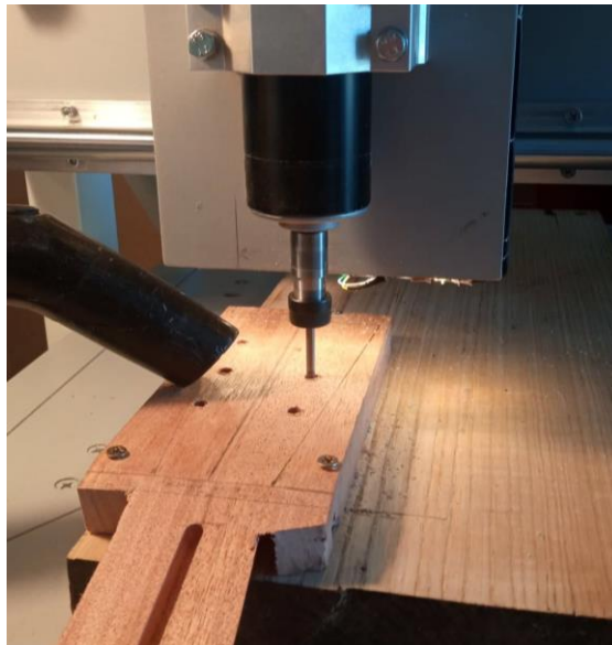
Slika 34. CNC bušenje rupa na glavi gitare
