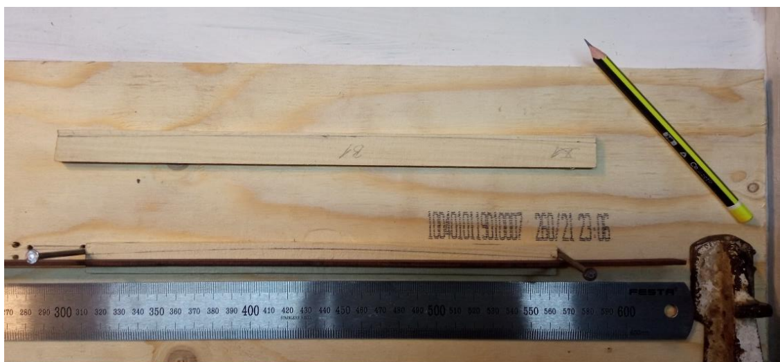
Slika 28. Obilježavanje radijusa elemenata ukrute stražnje ploče
