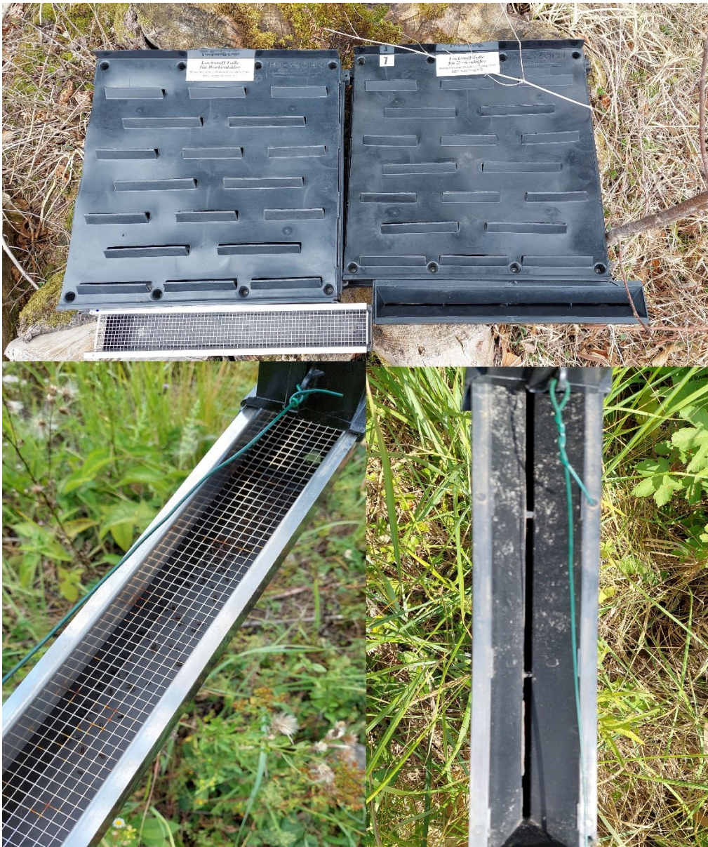
Slika 9 Feromonske klopke; lijevo-modificirana Theysohn®, desno-kontrolna standardna Theysohn®
