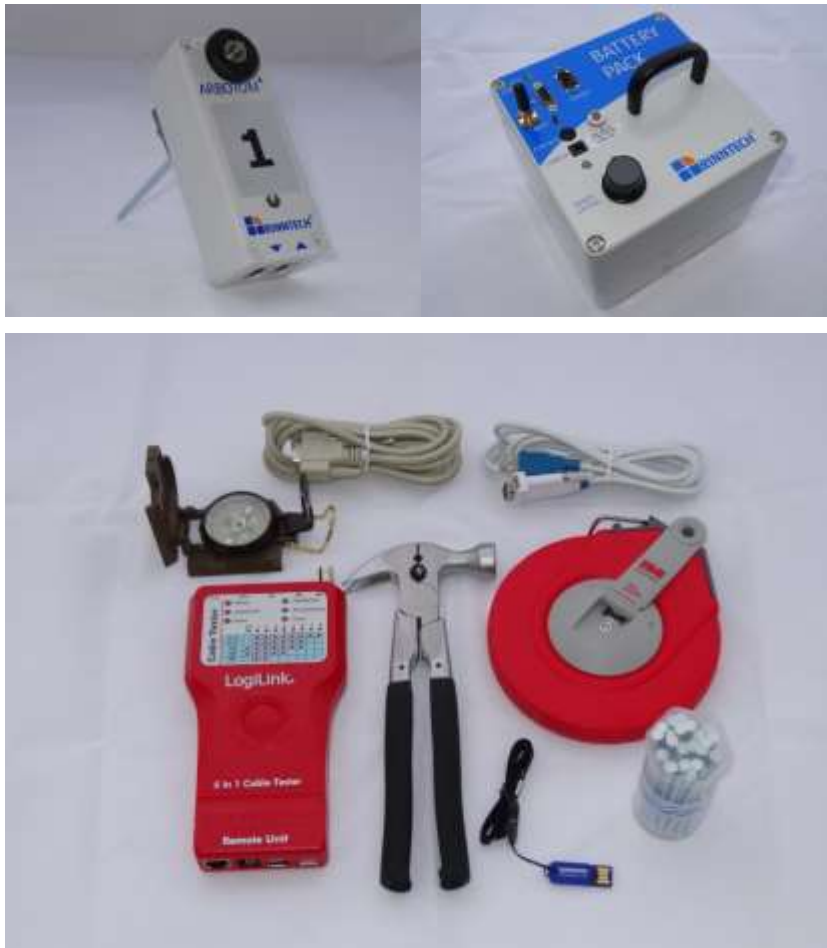
Slika 8 Prikaz dijelova tomografa
