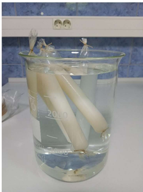
Slika 5. Dijalizacijske membrane napunjene smjesom nano celuloze i vode
