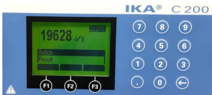
Slika 24. Rezultat mjerenja gornje ogrjevne vrijednosti kalorimetrom
