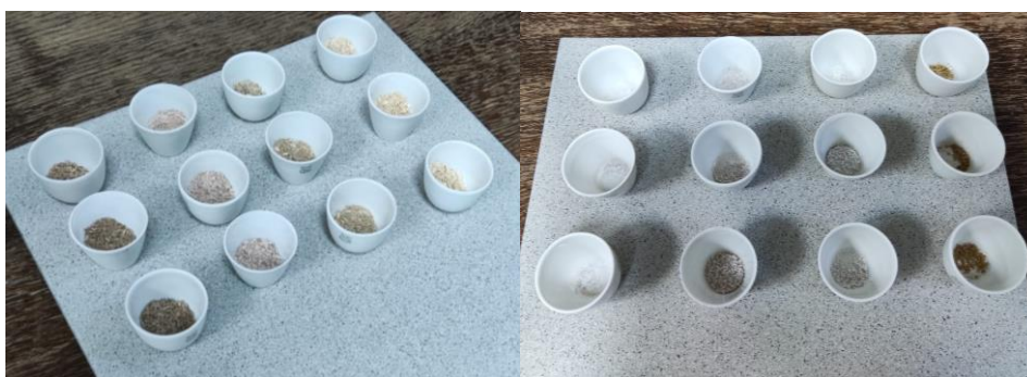
Slika 19. Uzorci prije (lijevo) i nakon (desno) spaljivanja
