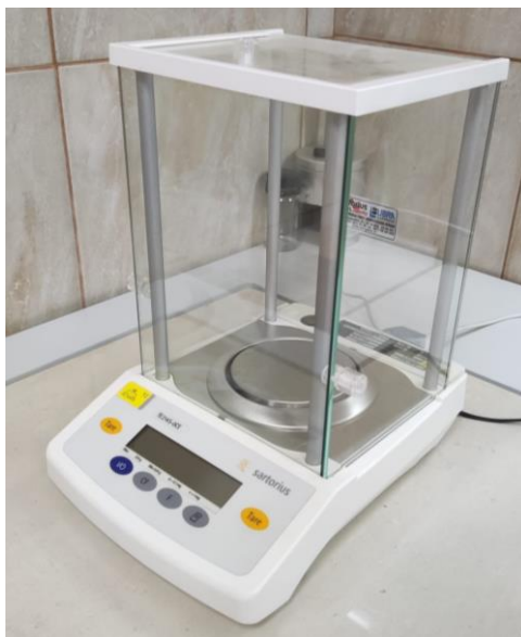
Slika 14. Analitička vaga Sartorius Talent TE214S-OCE
