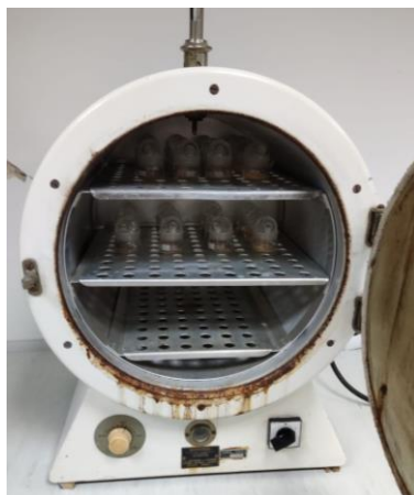
Slika 16. Sušionik Sutjeska s uzorcima u staklenim posudicama
