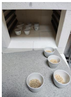
Slika 18. Stavljanje keramičkih posudica s uzorcima u mufolnu peć
