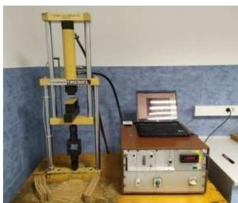
**Slika 23.** Univerzalni uređaj za ispitivanje mehaničkih svojstava *Schenck Trebel*
