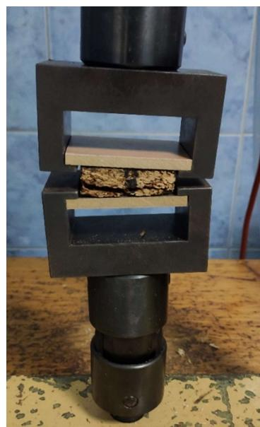
**Slika 25.** Uzorak („sendvič“) u hvataljkama uređaja
