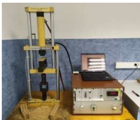
Slika 23. Univerzalni uređaj za ispitivanje mehaničkih svojstava Schenck Trebel (Izvor: Lasić, 2019)
