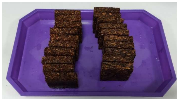
Slika 22. Ocijeđeni uzorci nakon potapanja u vodi
