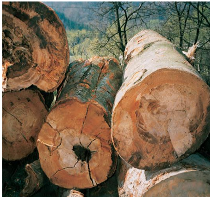
Slika 17. Primjer truleži bukve ( https://korak.com.hr/sto-utjece-na-promjenu-boje-drva-2/ )
