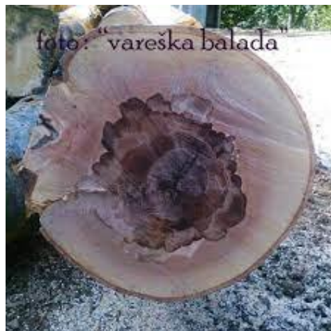
Slika 19. Primjer neprave srži bukve ( https://www.facebook.com/photo/?fbid=570945313034856&set=malo-%C5%A1u-marisanja-mrazna-sr%C5%BE-neprava-sr%C5%BE-na-trupcu-bukve-nast )
