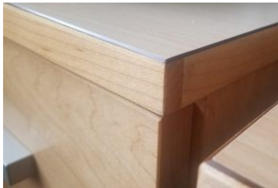
Slika 13. Rubna letvica izrađena od masivnog drva (Izvor: DCI Sustainable Hardwood Furniture https://dcifurn.com/edge-banding-everything-you-need-to-know/ ; Pristupljeno 5.9.2022.)
