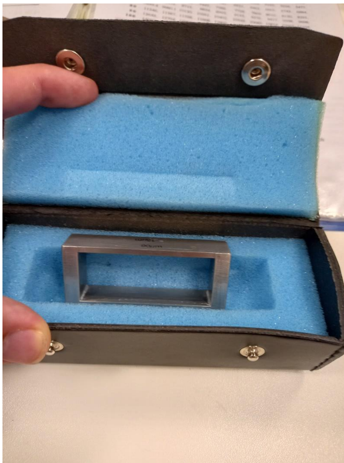
Slika 12. Kvadrantni profil za ravnomjerno nanošenje laka
