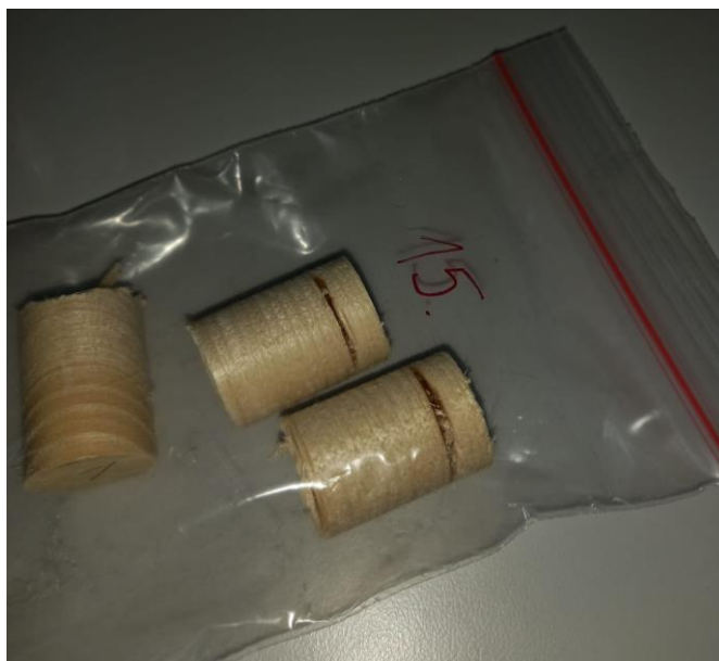
Slika 30. Smolni džep (foto: Sabljak M.,2022)
