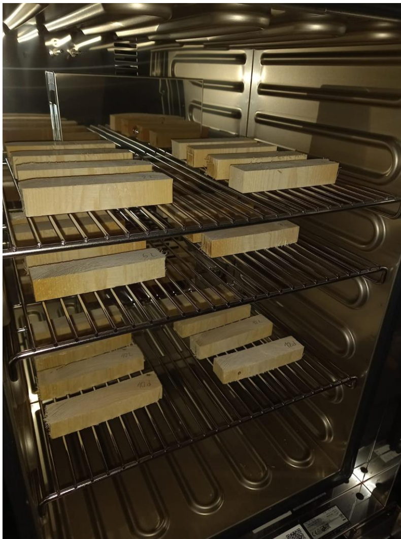
Slika 23. Sušenje kontrolnih uzoraka (foto: Sabljak M.,2022)
