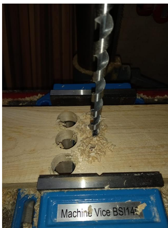
Slika 16. Izrada uzoraka spiralnim svrdlom (foto: Sabljak M.,2022)
