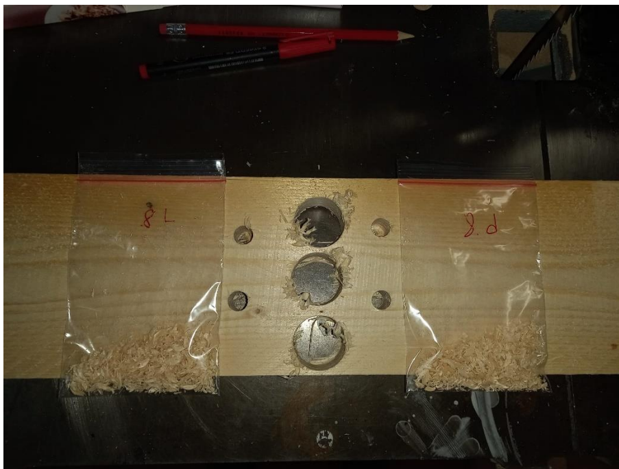
Slika 20. Uzorci lijeve i desne strane zapakirani u nepropusne vrećice (foto: Sabljak M.,2022)
