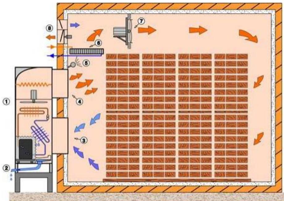
**Slika 4.** Presjek kondenzacijske sušionice
