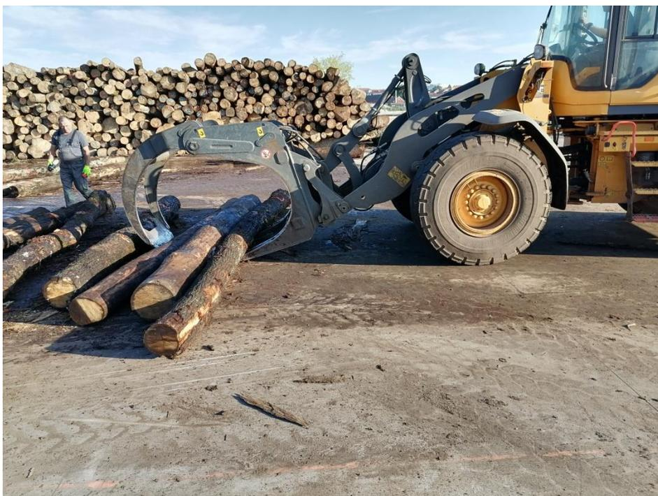
*Slika 20. Utovarivač sa specijalnim hvatalom za trupce*
