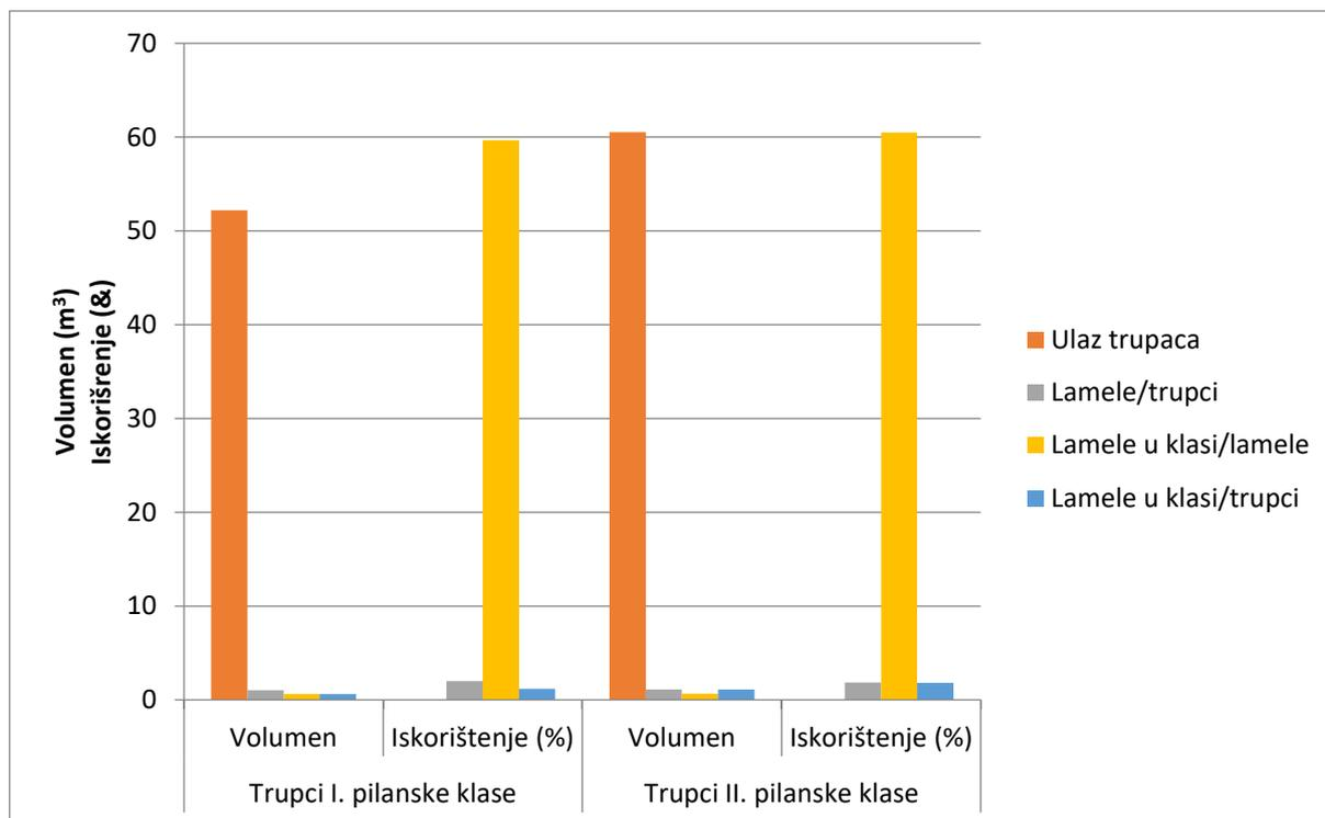
**Slika 35.** Grafički prikaz kvantitativnog iskorištenja pilanskih trupaca I, II, i III. klase pri izradi lamela u klasi ABCD dimenzija 2215x205x3,9
