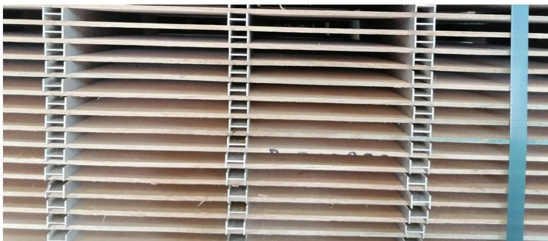
**Slika 23.** Aluminijske letvice („špangle“) u složaju lamela
