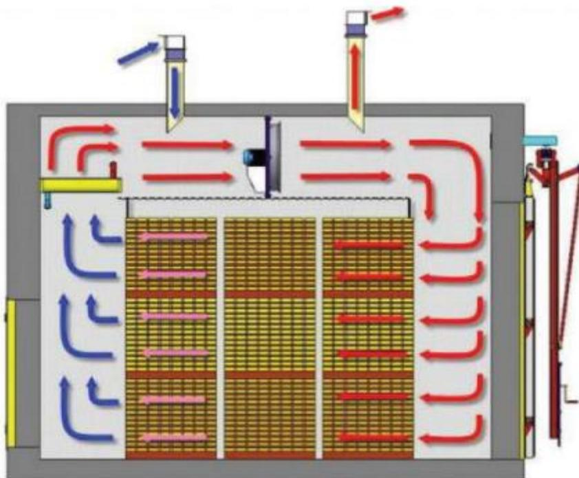
**Slika 3.** Presjek klasične (evaporacijske) komorne sušionice (izvor: peskiadmin.ru, 1.7.2022.)
