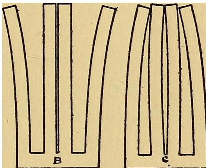
**Slika 13.** Prikaz uzoraka vilica za utvrđivanje skorjelosti
