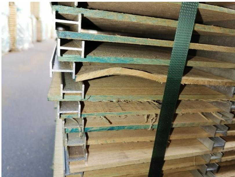
**Slika 17.** Vitoperenje hrastovih lamela uslijed nepravilnog slaganja složaja
