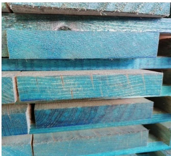
Slika 15. Čeone pukotine na hrastovim elementima
