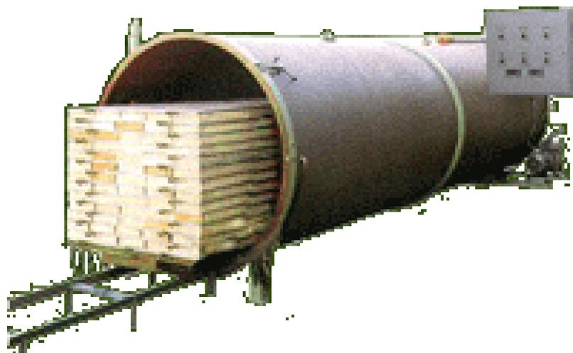
**Slika 6.** Vakuumska sušionica za drvo
