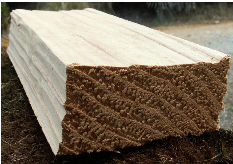
**Slika 16.** Prikaz kolapsa (spljoštenosti stanične stijenke) drva
