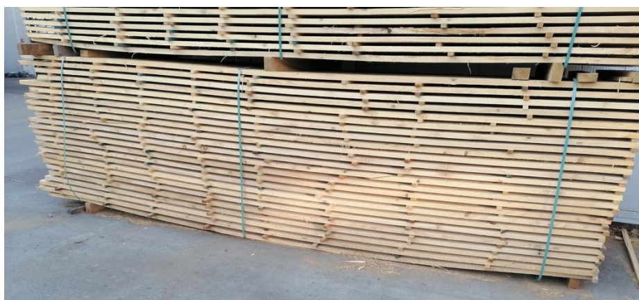
Slika 10. Nepravilan način slaganja horizontalnog razmaka špangli
