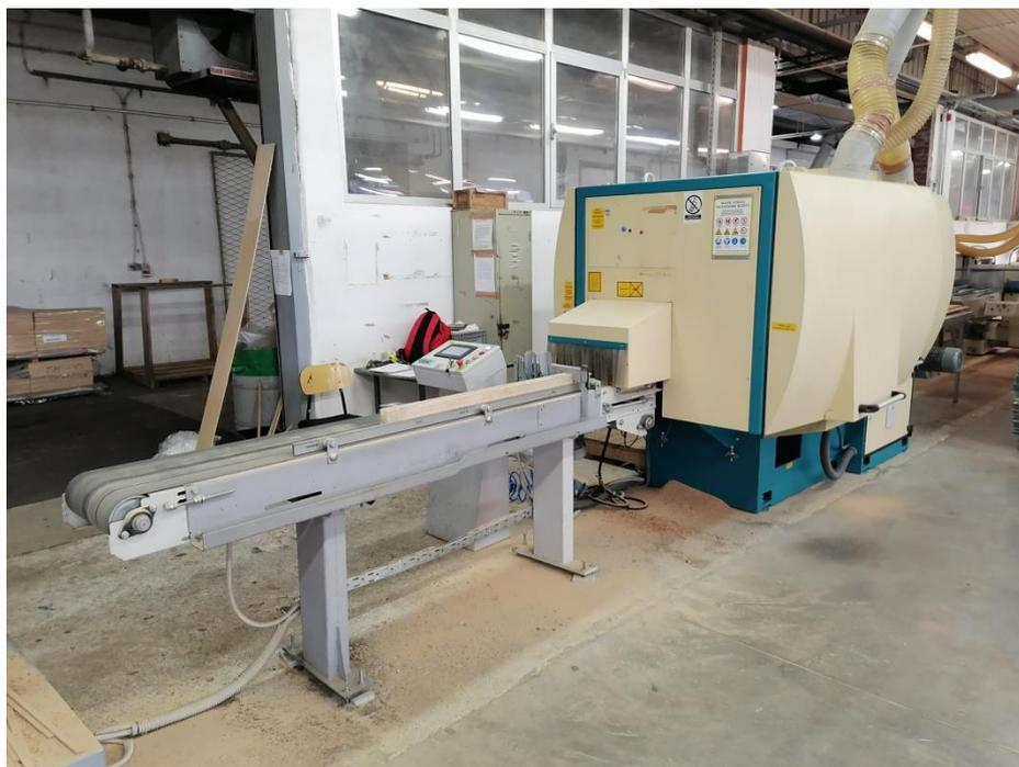
**Slika 24.** Stroj za čeono glodanje „Rotoles“
