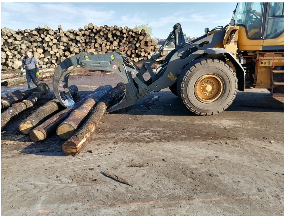
Slika 20. Utovarivač sa specijalnim hvatalom za trupce
