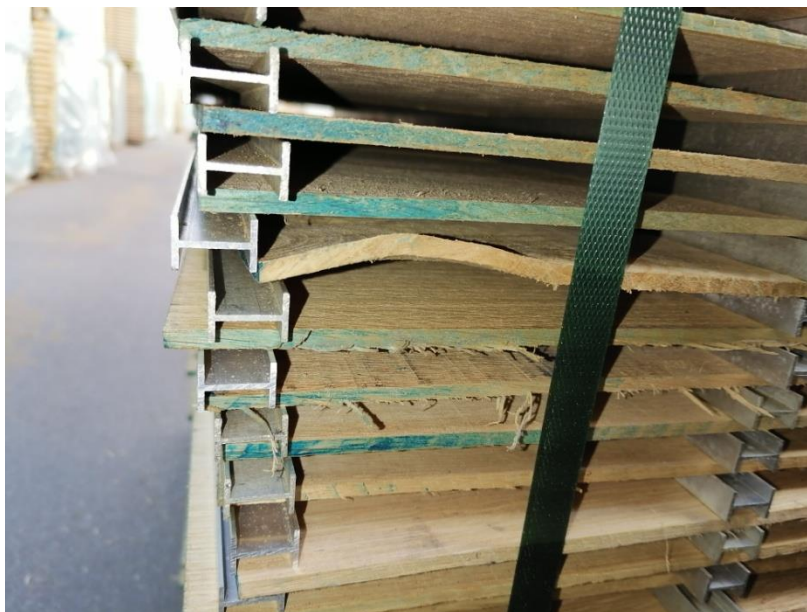
Slika 17. Vitoperenje hrastovih lamela uslijed nepravilnog slaganja složaja
