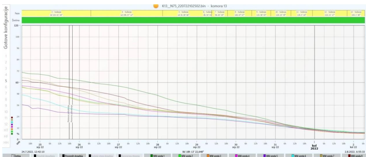
Slika 39. Graf sadržaja vode u drvu u ovisnosti o vremenskom periodu kod lamela dimenzija 2215x205x6,3 RUSTIK
