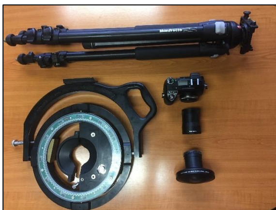
Slika 21. Dijelovi uređaja za snimanje hemisfernih fotografija
