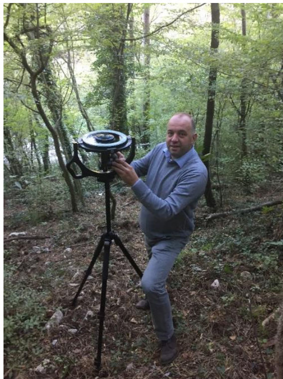
Prilog D.21. Snimanje hemisfernih fotografija za utvrđivanje svjetlosnih uvjeta u sastojinama
