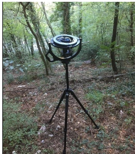
Slika 22. Postavljen uređaj za snimanje hemisfernih fotografija
