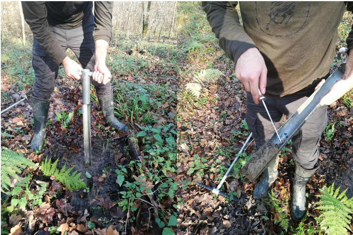
Slika 15. Uzorkovanje tla žljebastom sondom
