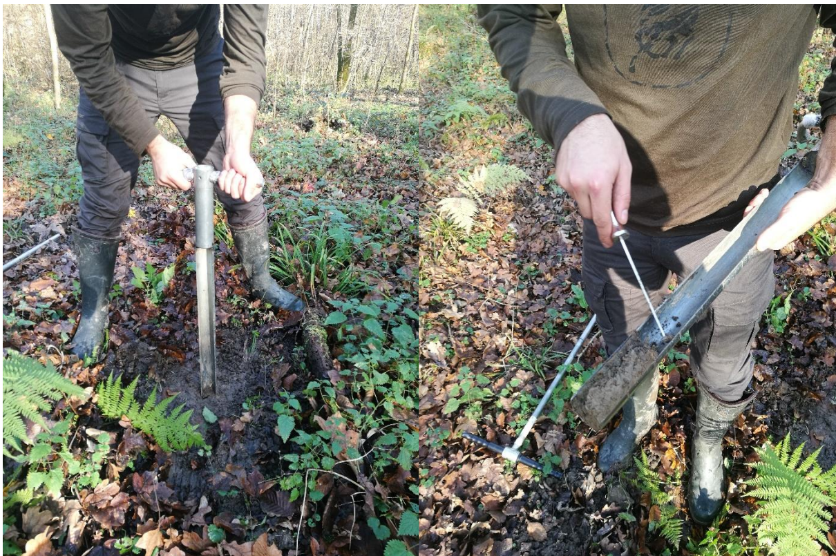
Slika 15. Uzorkovanje tla žljebastom sondom
