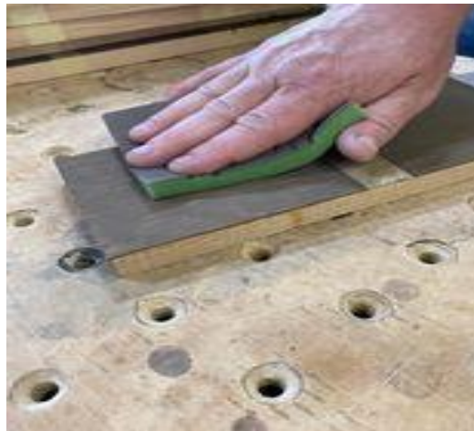
Slika 7. Brušenje močene površine brusnim papirom granulacije P280
