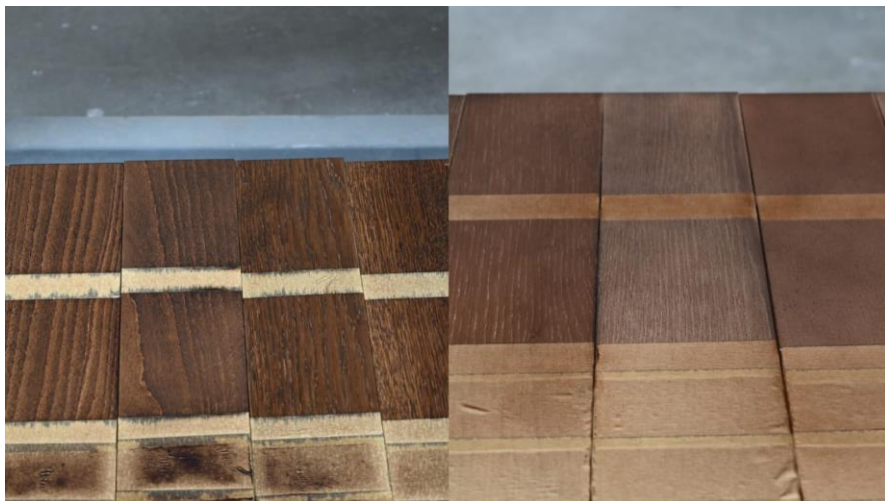
Slika 13. Lijevo: vodeni bajc; desno: nitro bajc
