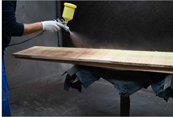
Slika 6. Nanošenje močila zračnim pištoljem
