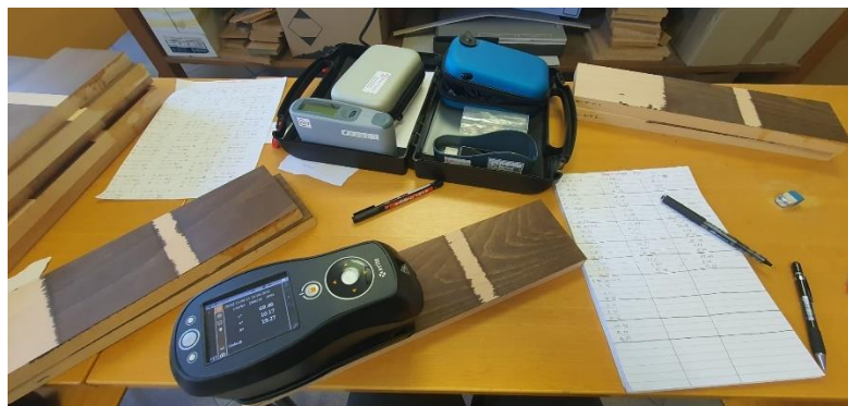
Slika 10. Mjerenje boje na uzorcima
