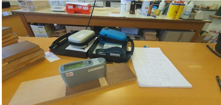
Slika 9. Mjerenje sjaja na uzorcima
