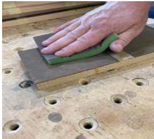
Slika 7. Brušenje močene površine brusnim papirom granulacije P280
