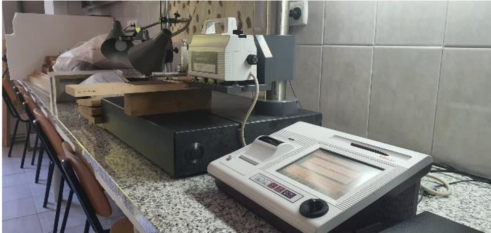
Slika 11. Mjerenje hrapavosti površine uzoraka
