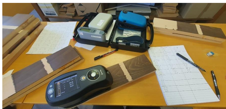
Slika 10. Mjerenje boje na uzorcima
